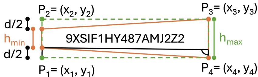
Abbildung 69.: Korrektur der horizontalen perspektivischen Verzerrung
