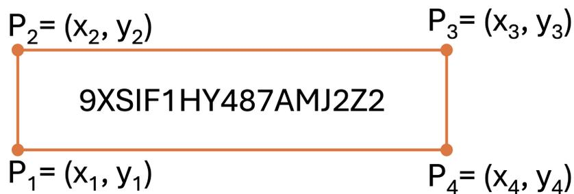
Abbildung 68.: Visualisierung der Eckpunkte der Boundary Box
