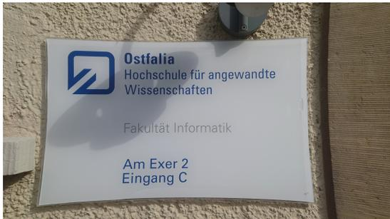
Abbildung 7.: Kissenförmige radiale Verzeichnung an der Gebäudeinformationstafel
