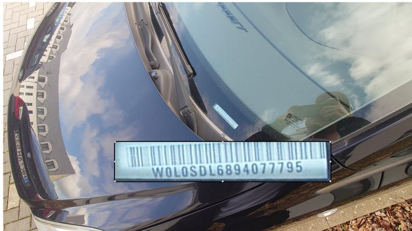
Abbildung 2.: Platzierung der VIN eines Fahrzeugs hinter der Windschutzscheibe
