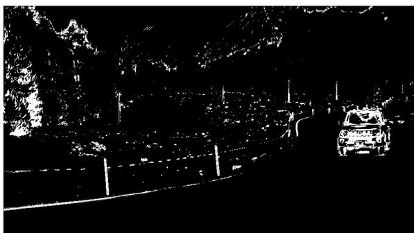
ABBILDUNG 40: BEISPIELMASKE DES RANDOM FOREST-ALGORITHMUS MIT DEM RGB-BILD ALS EINGANG
